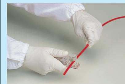
注意 チューブ切断部分に汚れ、へこみ、傷、つぶれ、バリ、毛羽立ちなどがないようにカットしてください。また、チューブを斜めに切断しないでください。チューブ挿入時に継手のシール部分を傷つけ、漏れの原因となります。
