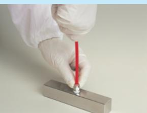
注意 チューブを継手本体の奥へ押し込まず、リリースの押し込みが不十分な状態でチューブを引っ張ったりねじったりすると、チューブが抜けなくなることがあります。
